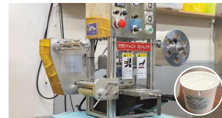
衛生安全面を向上させるため導入されたインナーシール機
